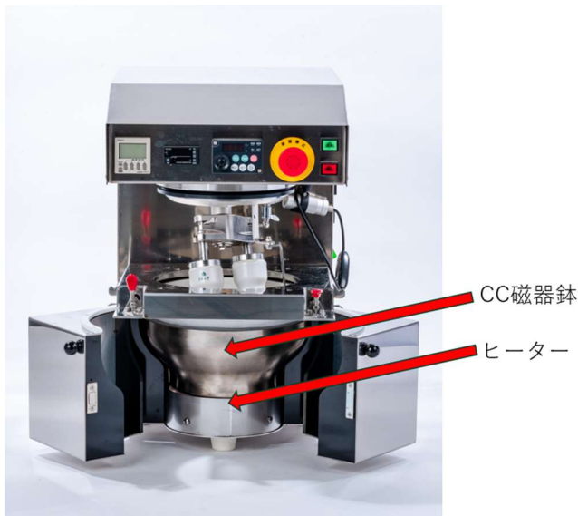
図 2. D18SEB のヒーターと CC 磁器鉢写真
